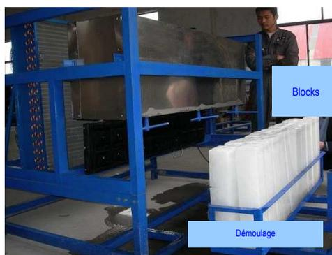
L'ouverture simple du système de fabrication permet de faire glisser par le bas les blocs de glace
