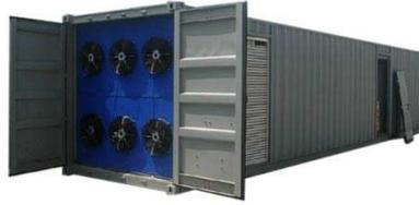
Contrairement aux systèmes classiques de fabrication de glace qui utilisent un système complexe avec de la saumure nécessitant au moins 12 heures pour la production de barres de glace, l'**ICE BLOCK FACTORY**, utilise un réfrigérant circulant dans des plaques d'aluminium qui permet la production ultra rapide de barres de glace en 4 heures.
